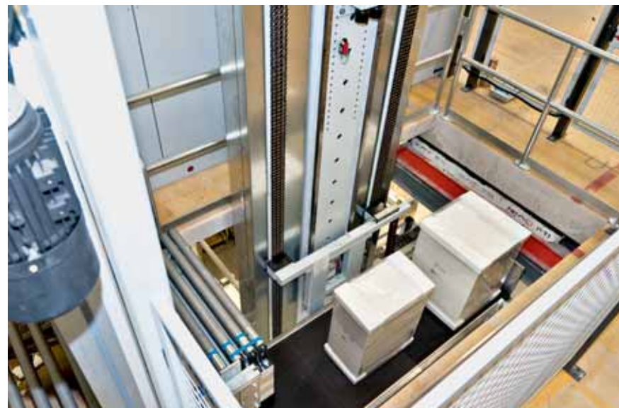
Eine planerische Meisterleistung: die Transportlinie mit Aufzug. Die Verpackung der Korpusse erfolgt in der zweiten Etage, der Versand in der ersten Etage
