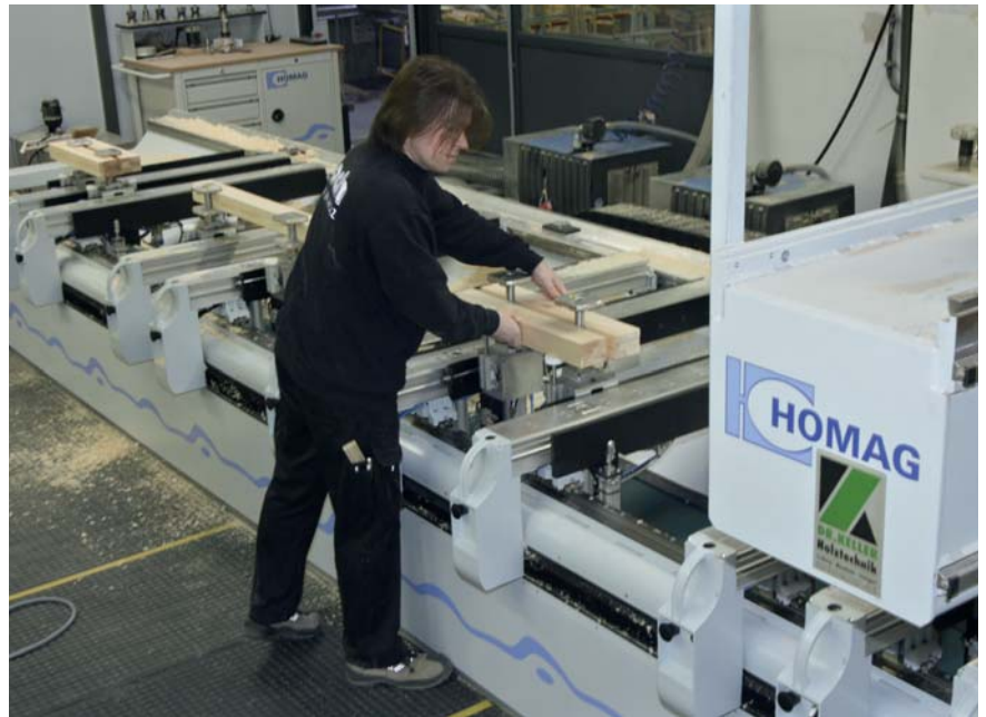
Neben dem Bearbeitungszentrum „BOF 211“ mit Mehrfachbelegung setzen die Kochs, betreut durch den Vertriebspartner Dr. Keller, weitere Maschinen aus der Homag Group ein.
