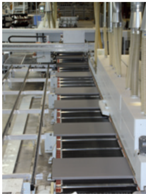
Den Automatisierungsgrad und die Flexibilität erhöhen, die Personalkosten reduzieren – dies waren einige der Ziele, die die Recor-Gruppe mit der Umgestaltung ihrer Kastenmöbel-Fertigungslinie erreichen wollte. Die Abstapelung nach der HOLZMA Säge ist bislang einmalig in ihrer Ausführung.
