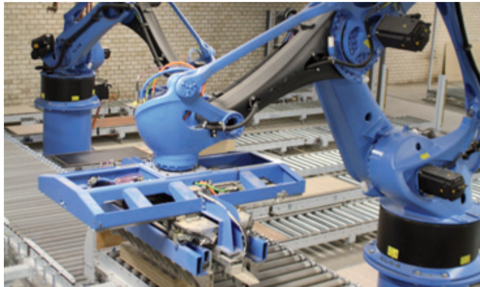
Den Automatisierungsgrad und die Flexibilität erhöhen, die Personalkosten reduzieren – dies waren einige der Ziele, die die Recor-Gruppe mit der Umgestaltung ihrer Kastenmöbel-Fertigungslinie erreichen wollte. Die Abstapelung nach der HOLZMA Säge ist bislang einmalig in ihrer Ausführung.
