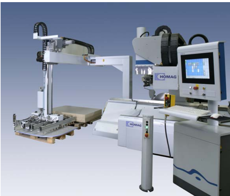
Abb. 2: TBA 330 beim ablegen eines Werkstücks
