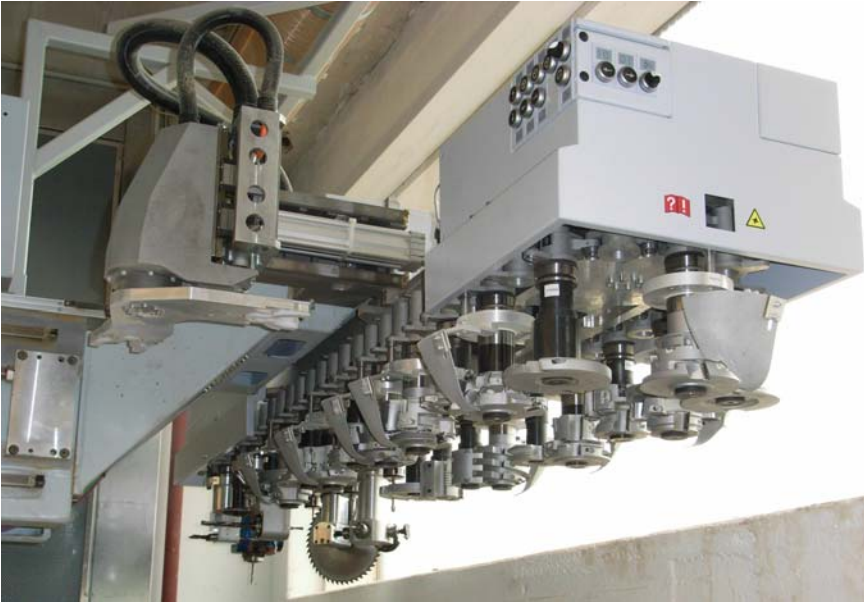
Bild 4: 30-fach Kettenwechsler mit Profilwerkzeugen und Aggregaten
