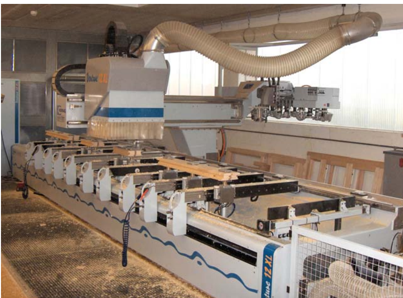
Bild 2: Bearbeitungszentrum Venture 12 mit 30-fach Kettenwechsler
