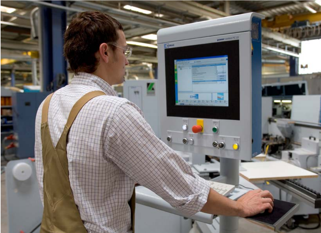
Bild 2: Bedienung der Produktionsliniensteuerung woodLine 3.0
