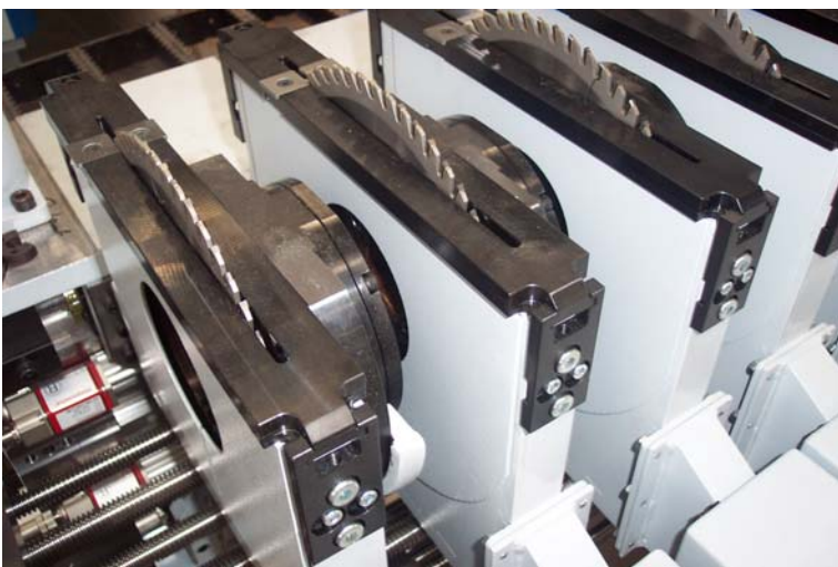
Bild 2: Flexibel positionierbare Sägeaggregate (Maschinentype FSL 420)
