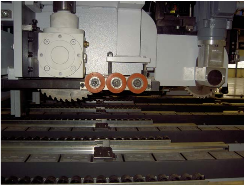
Bild 1: Mehrfachaufteilung mit Vorritzen und Nockenkette für genauen Schnitt (Maschinentype FSQ 380)
