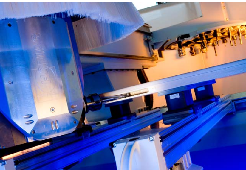
Bild 4: Schlosskastenfräsung mit DRIVE5+ Fünf-Achs-Frässpindel
