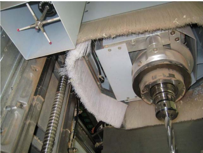
Abb. 4: Eine der Hauptbearbeitungsspindeln, daneben eine der zweit Messtastereinheiten
