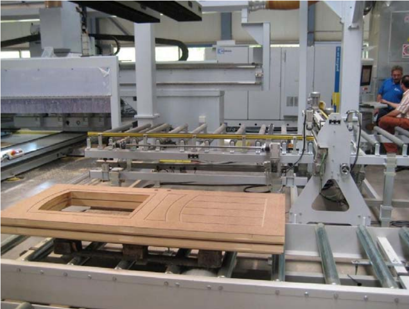
Abb. 3: Fertige Türblätter auf einem der Bearbeitungstische
