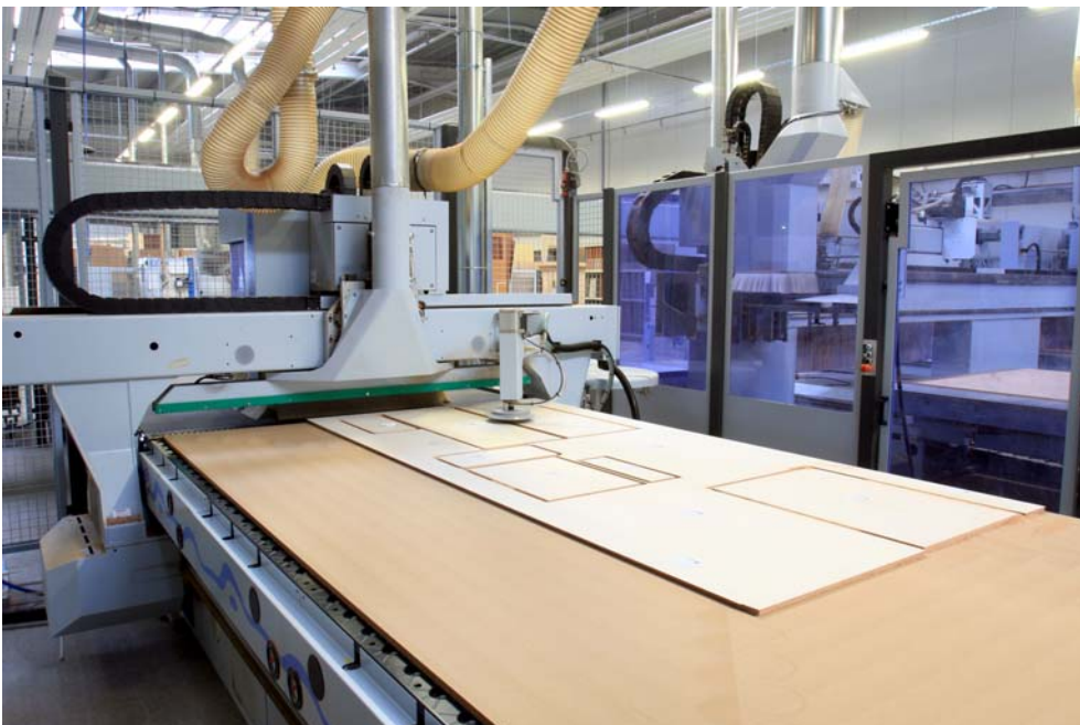
Bild 4: Zelle 2 WEEKE Bearbeitungszentrum für automatische und manuelle Zufuhr
