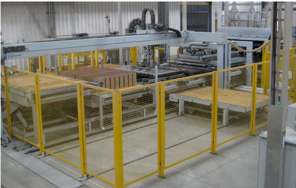
Bild 6: BARGSTEDT Streifenausrichtung und Ab stapelung auf Ladegutträger
