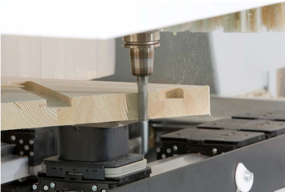
Bild 2: Bearbeitung einer Treppenwange
