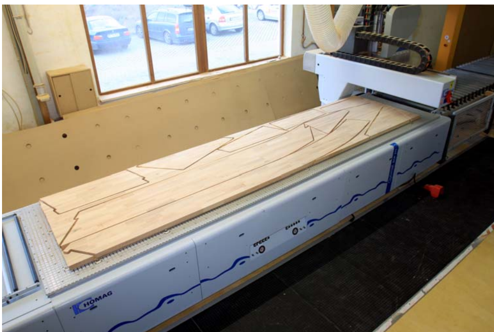
Bild 6: Verschnittoptimiertes Aufteilen von Leimholzplatten im Nesting-Verfahren
