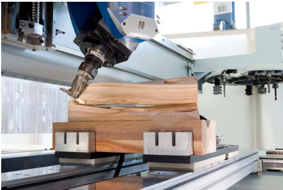
Bild 5: 5-Achs-Bearbeitung eines Handlaufkrümmllings
