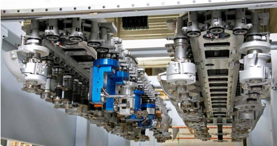
Bild 5: multiChain Werkzeugwechsler mit 17 Fenstersystemen
