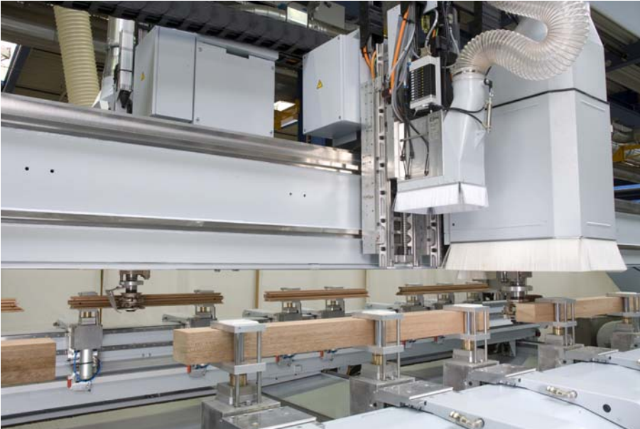
Bild 4: Zeitgleiche Komplettbearbeitung von mehreren Werkstücken
