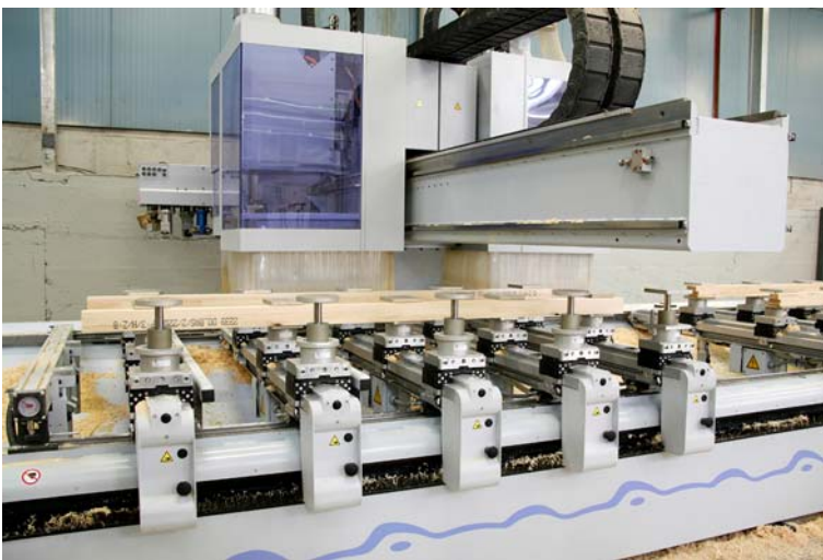
Bild 6: Bearbeitungszentrum BOF 322 mit automatisch rüstendem Tisch
