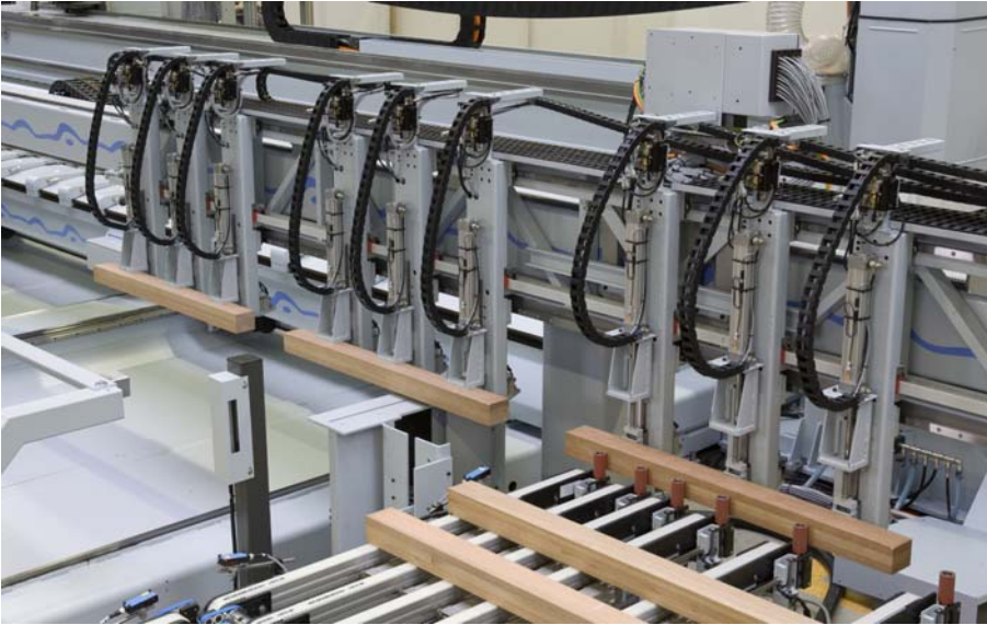
Bild 3: Zuführeinheit mit Ablängsäge
