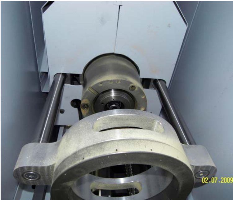
Bild 3: Elektronische Spindeltastung (Sensoflex) für Applikationsbearbeitung
