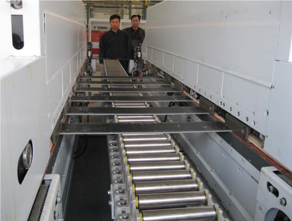
Bild 1: Transport der dünnen, flexiblen, massiven LVT-Werkstücke durch die Querprofilierung
