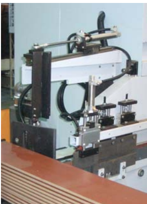
Bild 3: Optimiertes Magazin am Einlauf der Quermaschine
