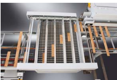
Bild 9: Versetzstation des FPR 262
