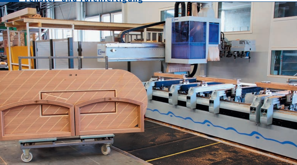
Das neue Mitglied im Maschinenpark: Die Venture 12XXL ist flexibel und auf die Sonderfertigung von Fenstern und Türen bestens eingestellt
