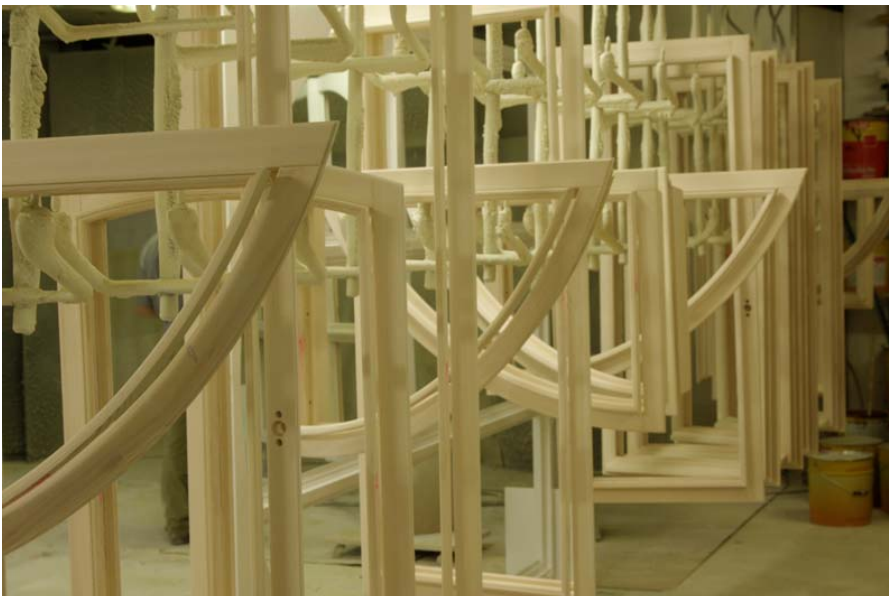
Bild 4: Fensterprofile – inklusive Glasleisten mit Gehrungsschnitt
