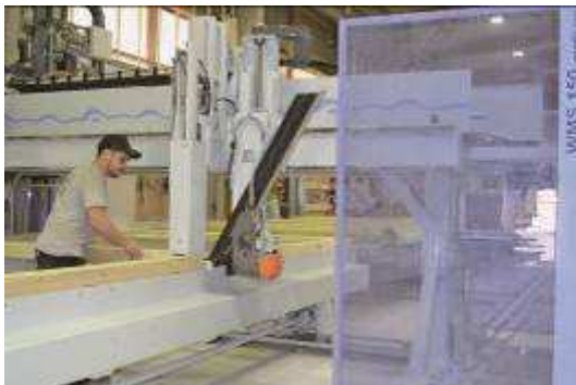
Bild 2: Automatisierte Herstellung des Riegelwerks mit der kompaktPLUS
