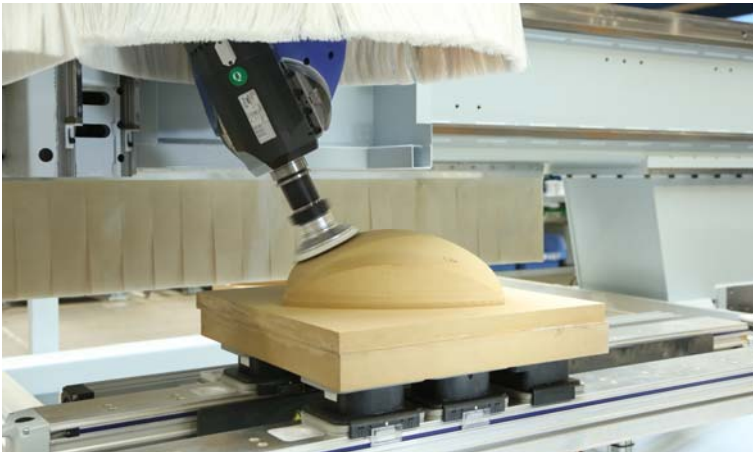
Bild 1: Egalisieren der Frässpuren nach der Fräsbearbeitung eines MDF-Formteils
