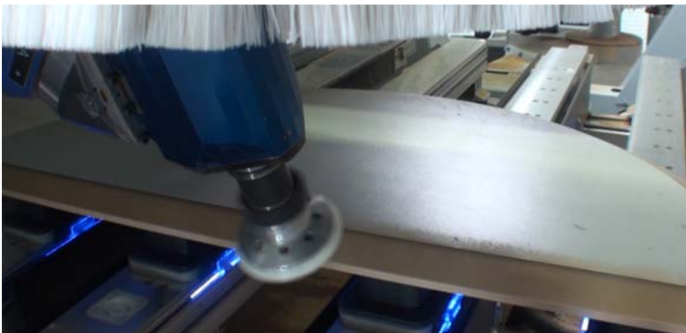
Bild 5a: Nachschleifen einer Fase an einer Tischplatte
