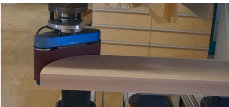
Bild 3: Kanten Nachschleifen mit dem Bandschleifaggregat
