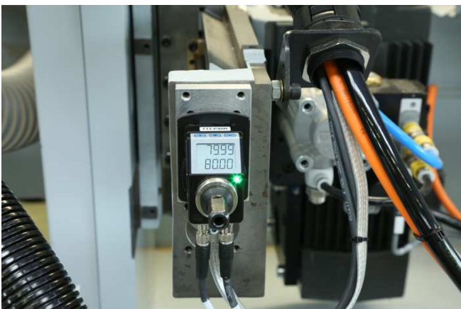
Bild 3: Manuelles Verstellen von Aggregaten mit zusätzlichen Hilfsmodulen und intelligenter HOMAG Steuerung ergibt enorme Rüstzeiteinsparungen.
