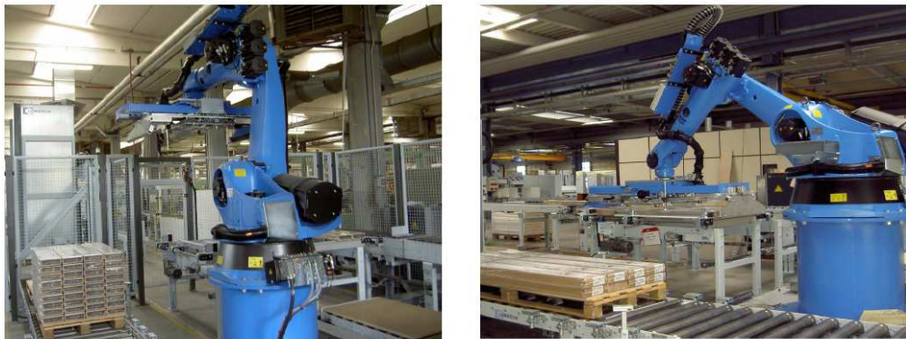
Bild 5: Palettieren mit Robotertechnik: einfaches Umrüsten via Steuerung
