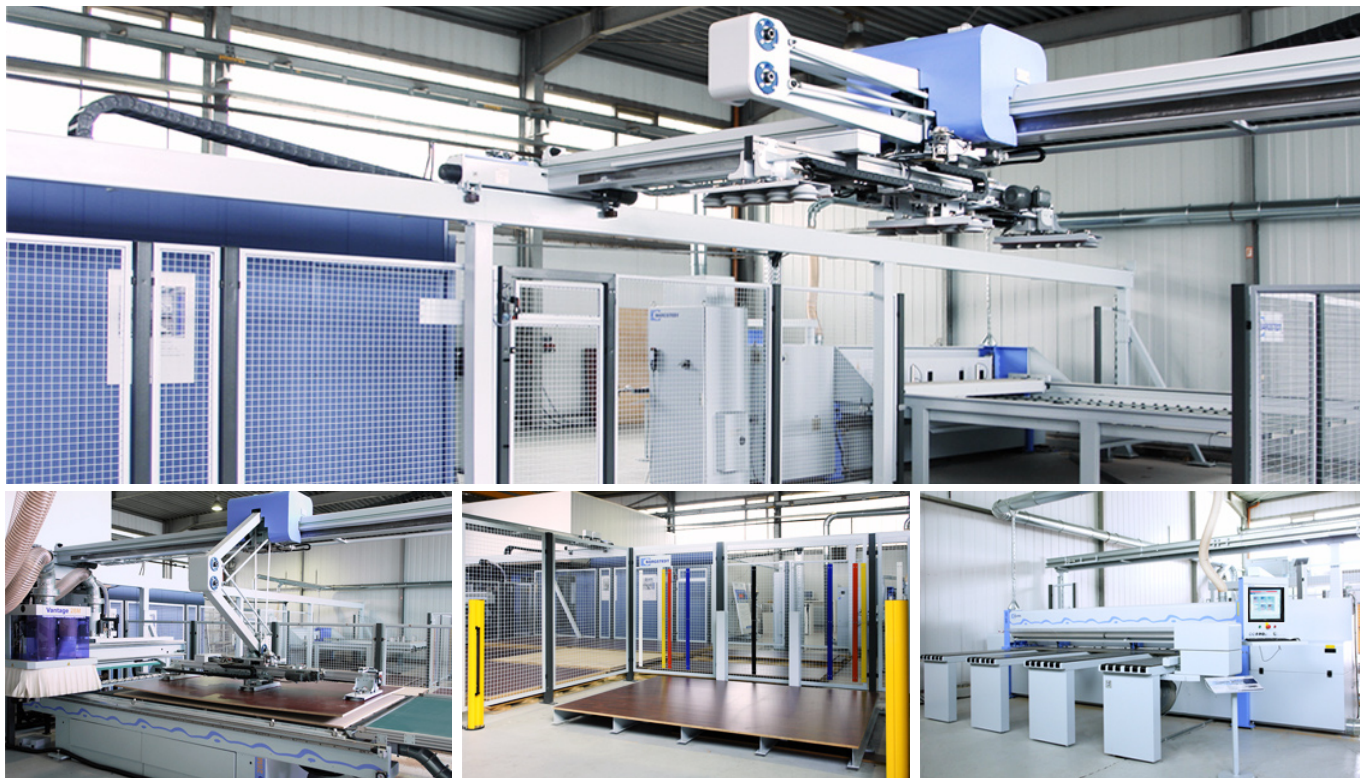
Systemkompetenz - Lager mit Bearbeitungsmaschinen HPP 250 von HOLZMA und Vantage 28M von WEEKE
