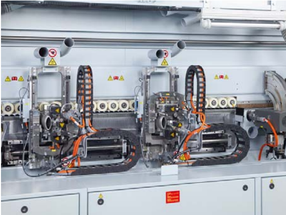
Bild 2: Keine Einschränkungen bei der Eckenbearbeitung – Das Servotrim Formfräsaggregat
