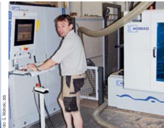
... und gibt die Daten in die Werkzeugdatenbank des BAZ ein. Hier wird er auch jede Maßänderung nach dem Schleifen eintragen. ...
