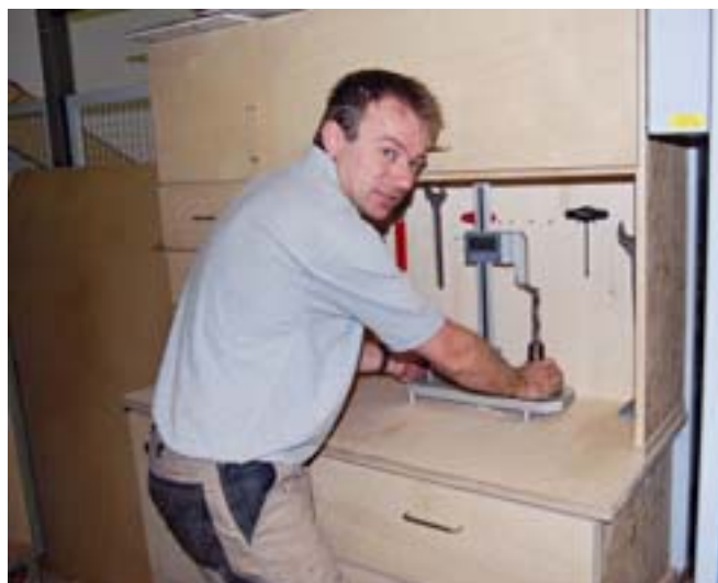
So gelangen die Werkzeugdaten in die Maschinensteuerung und das CAD/CAM-System: Zuerst vermisst Weinzierl einen neuen Schafffräser ...
