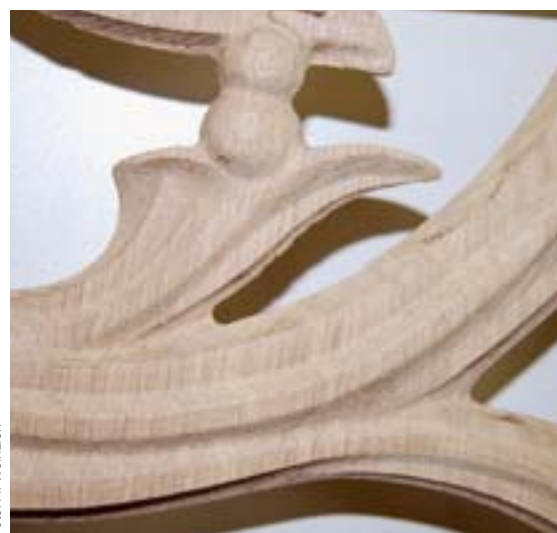
... Solche Gebilde generiert er aus 2-D-Zeichnungen. Die Technik kommt aus der Filmanimation
