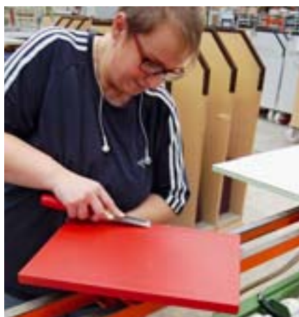
Hier entfernt eine Mitarbeiterin einen PUR-Wulst, der sich erst nach dem Bekanten gebildet hat
