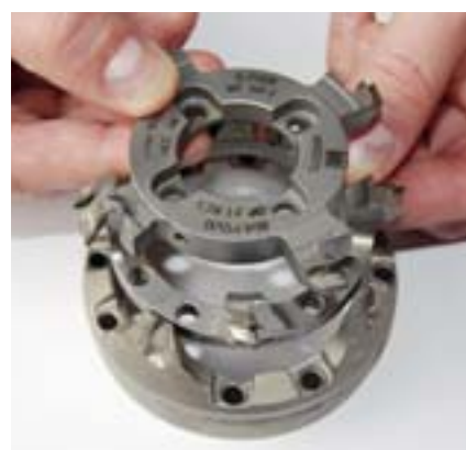
Stets drei Profile parat: Dieses Werkzeugpaket ermöglicht den Profilwechsel in der Werkstücklücke
