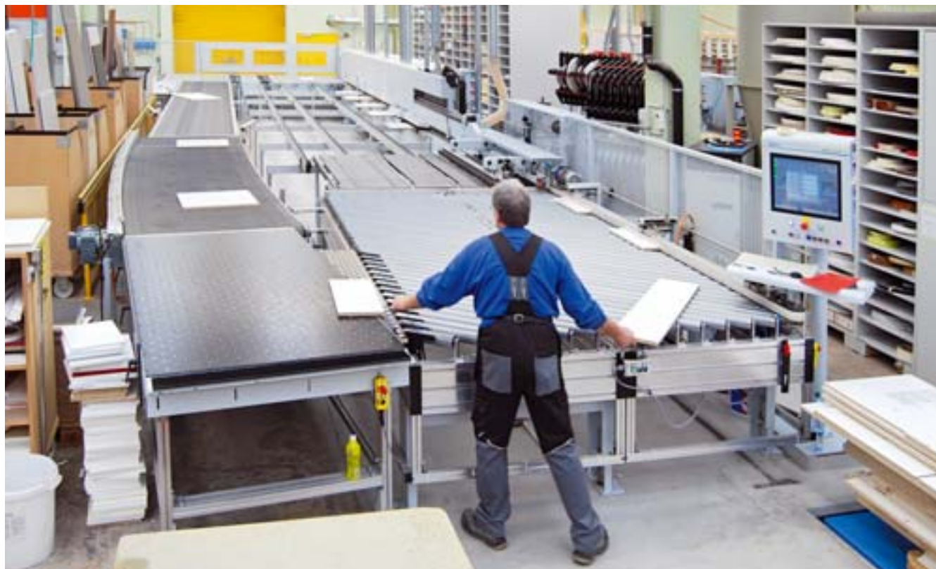
Der neue Frontenbekahter bei Elbau-Küchen: Ein Mann bewältigt hier in einer Schicht 1200 Laufmeter in 1600 Durchgängen
