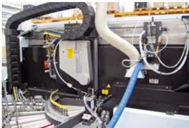
Bekantungsstation: von links lässt sich das Laseraggregat einschieben, von rechts der PUR-Beleimer
