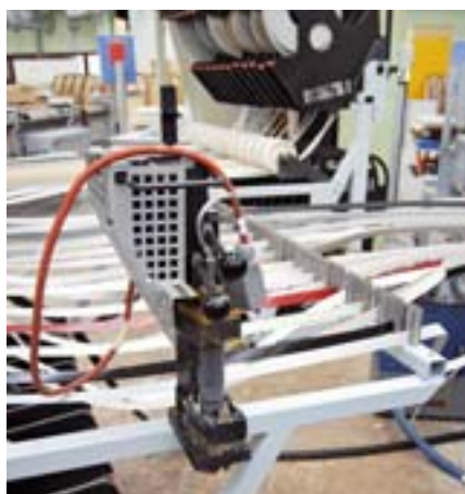
Geparktes Leimbecken: Der Wechsel zwischen Laser und PUR erfolgt bei Elbau manuell
