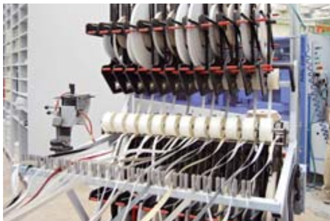
Flexibel für die Stückzahl-1-Fertigung ausgelegt: das bequem zugängliche 24-fach-Kantenbandmagazin, links dahinter das Kantenregal
