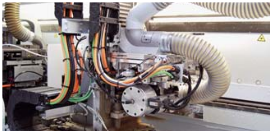
Das von Linearmotoren angetriebene Aggregat folgt dem Werkstück, tastet und profiliert die Ecken
