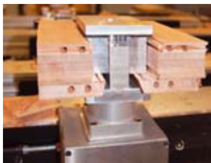
Klotzzulagen in den Glasfalten übertragen den Druck des Spannelementes
