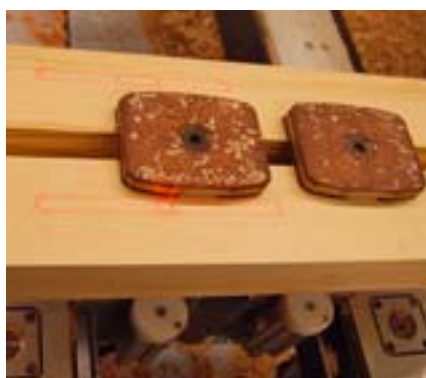
Die Spanner positionieren sich automatisch. Trotzdem zeigt der Laser auf die Fräsbereiche
