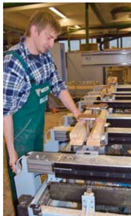
Umspannen der sechs Kanteln nach dem ersten Bearbeitungsgang
