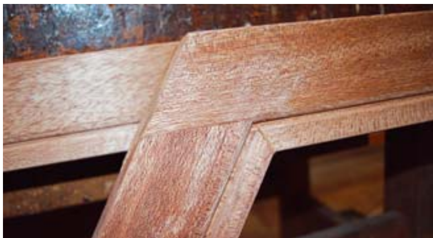
Keine V-Fuge, keine Schwachstelle: Beck Fensterbau schleift die Fenster nach dem Verleimen
