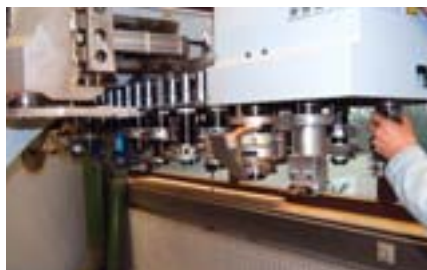
Beim Wechsel zwischen den Fenstersystemen sind drei bis vier Werkzeuge auszutauschen
