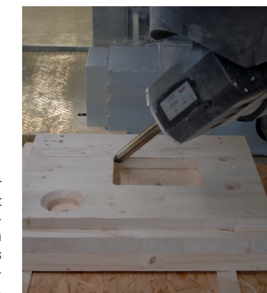
Das Kreissäge der WMP 250 erreicht eine Schnitttiefe bis 350 mm, kann um 360 Grad gedreht und bis 90 Grad geschwenkt werden
