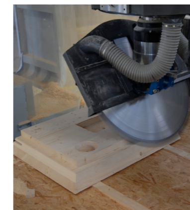
Das Kreissäge der WMP 250 erreicht eine Schnitttiefe bis 350 mm, kann um 360 Grad gedreht und bis 90 Grad geschwenkt werden
