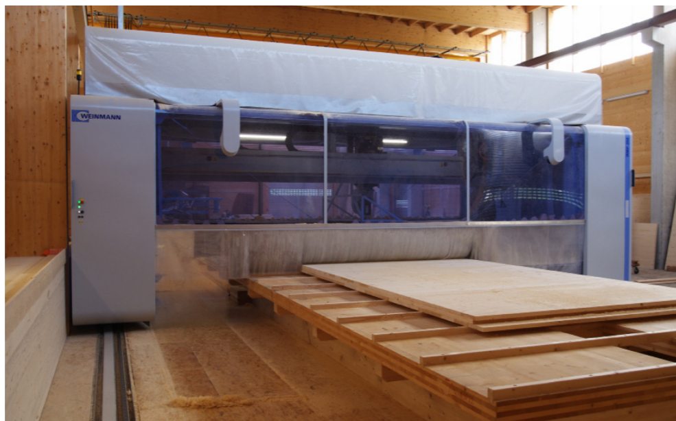
Die WMP 250 bearbeitet Massivholzelemente bis zu einer Länge von über 50 Metern.
