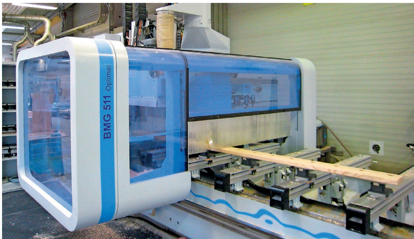
/ Das Fünfachs-CNC-Bearbeitungszentrum BMG in Fahrportalbauweise im Einsatz bei Erhard Sport. Der Maschinenständer aus dem Mineralguß-Werkstoff Sorbtech sorgt für hohe Schwingungsdämpfung und Präzision.
