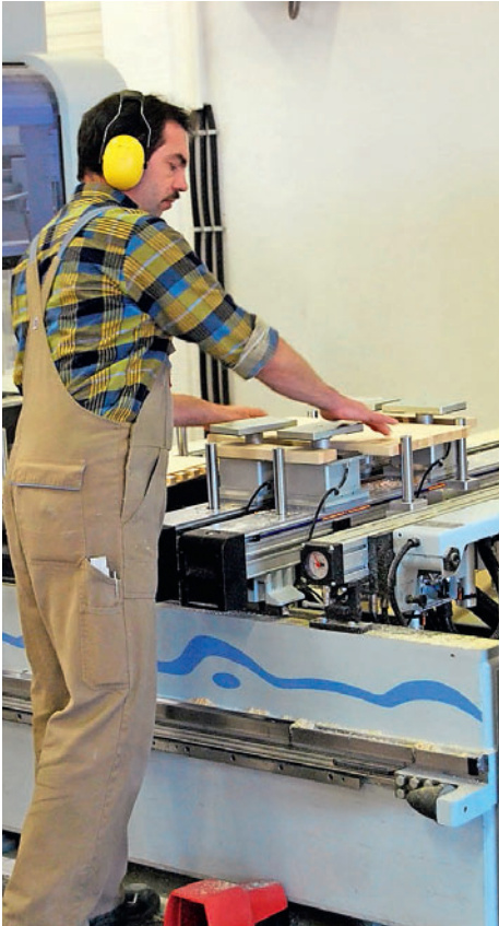
/ Sicherheit integriert: Beim Einspannen der Werkstücke wird mit Niederdruck (0,6 bar) gearbeitet.
