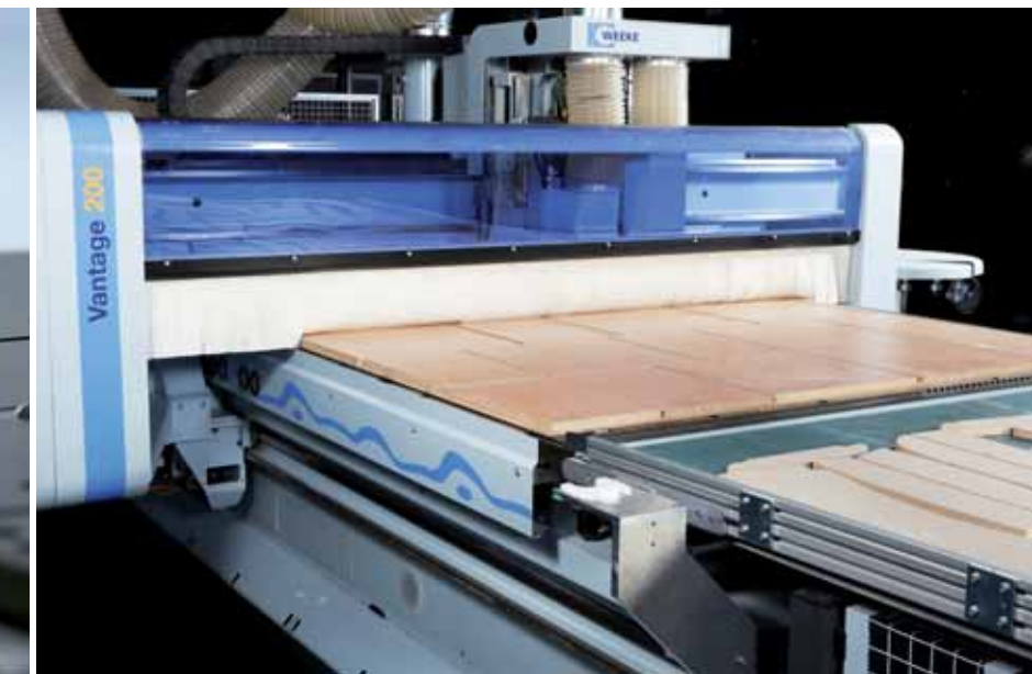
Links: Ideale Kombination: Das Bargstedt-Lager „TLF 210“ mit Sägen der „HPP“-Baureihen von Holzma. Mitte: Präzision und Geschwindigkeit aller Maschinen werden laufend verbessert. Rechts: Die Nestingmaschine „Vantage 200“ von Weeke
