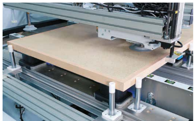
▲ Der TBA positioniert die Werkstücke genau an die vorgesehene Anschlagkante
