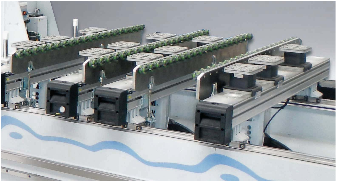
▲ Ein aktivierbares Rollensystem an den Auflagern sorgt dafür, dass die Werkstücke vom TBA exakt positioniert werden können (Bilder: Weeke)
