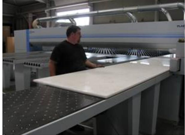
Überzeugend: Selbst Kunststoffplatten von 6 Metern Länge werden dank der bedüsten Tische mit nur einer Hand bewegt ...
