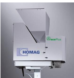
Bis zu 30 % reduzierter Druckluftverbrauch beim neuen Vorschmelzer des Verleimteils
