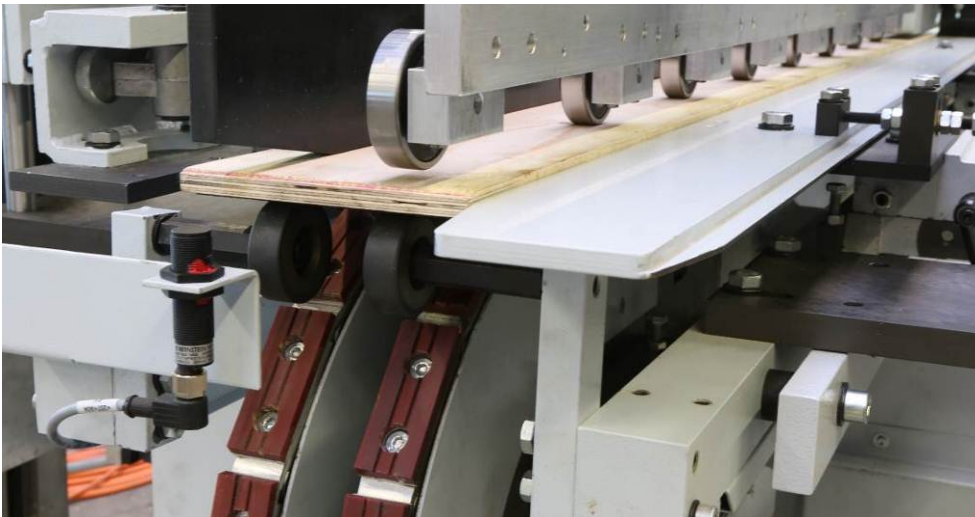
Bild 4: Einstieg in die doppelseitige Profilierung: Hohe Bearbeitungsgenauigkeit und lange Lebensdauer durch die rollende Kette
