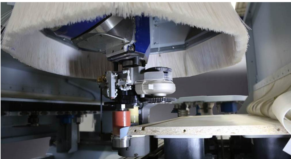
Bild 5: Das patentierte easyEdge : Kantenanleimen mit der DRIVE5C+ 5-Achs-Spindel
