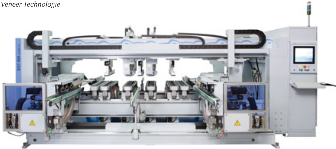
„BST 800“ Durchlauf- bohrmaschine – Sekunden- schnelles Um- rüsten mit Bohren von unten und oben mit bis zu 640 einzeln abrufbaren Bohrspindeln
