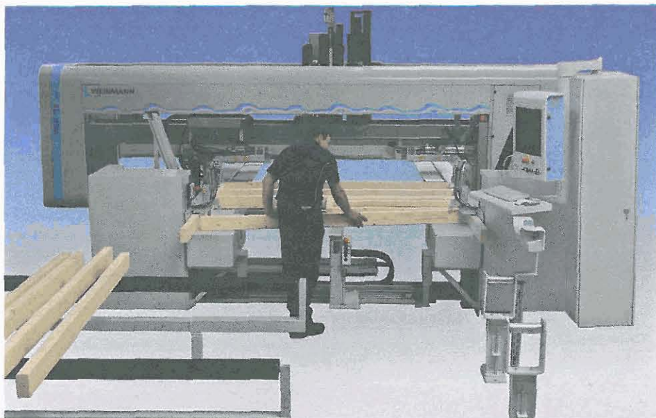
Multifunktionsbrücke und Riegelwerkstation „WEK 120“ mit geringem Platzbedarf (Weinmann)
