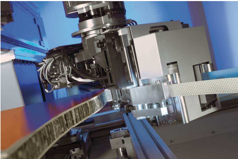
Bild 3: Kantenverschluss mit doubleEdge bei riegellosen Wabenplatten in einem Arbeitsgang
