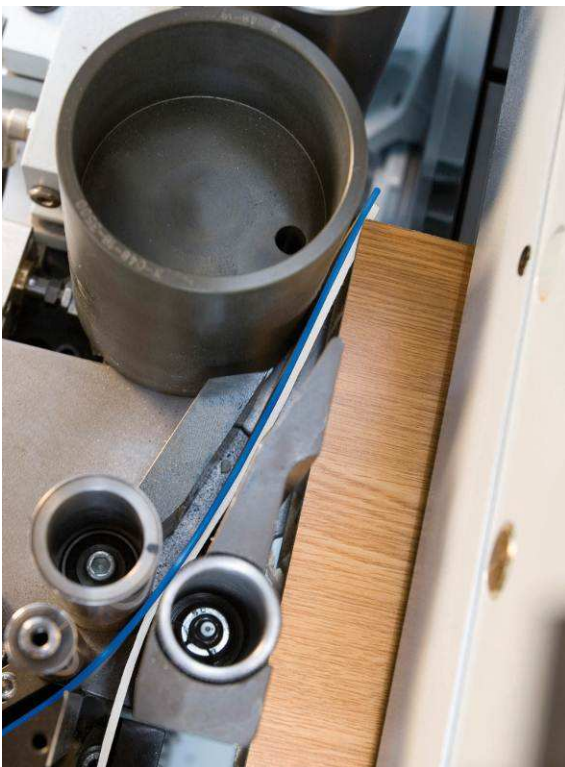
Bild 2: Direkt vor der Kantenanleimung werden beim patentierten doubleEdge Verfahren Stütz- und Dekorkante zusammengeführt
