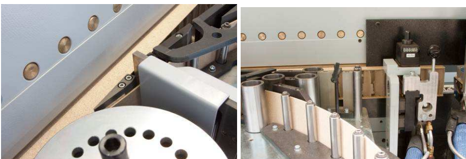
Bild 4: Heranführen der Stützkanten an die Wabenplatten und Kantenverschluss durch Anleimung
