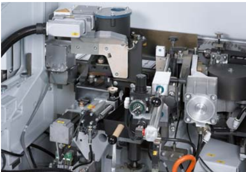
Bild 3: BRANDT-Verleimteil QA 45 mit geringer Aufheizzeit und schnellen Umrüstmöglichkeiten
