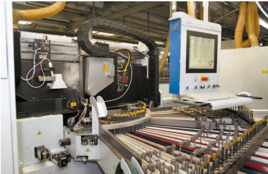
▲ Laseraggregat und volles Kantenmagazin einer Homag KFL 610 power line bei der Veriset Küchen AG
