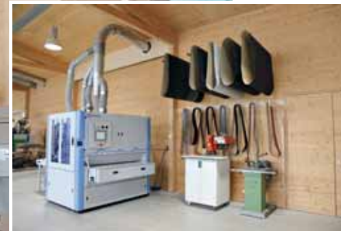
Die „SWT 325 QX“ mit X-Aggregat und 1350 mm Arbeitsbreite in der Design.S-Produktion
