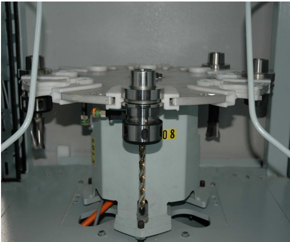
Bild 4: Sägezentrum WBS 140 mit Werkzeugwechsler
