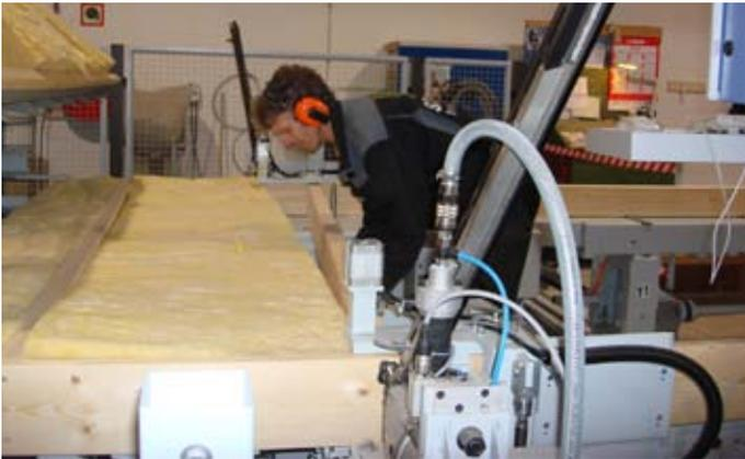
Einbau der Isolation an der Riegelwerkstation / Installation of insulation at the framing station
