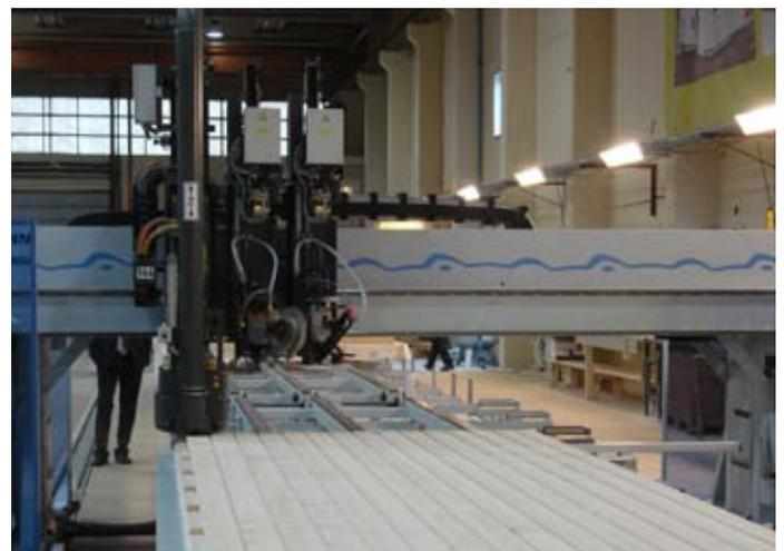
Automatisches zuschneiden und befestigen der Schalung mit der Multifunktionsbrücke
