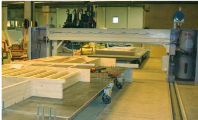
CNC-gesteuerter Dach- Deckentisch / CNC-controlled assembly table
