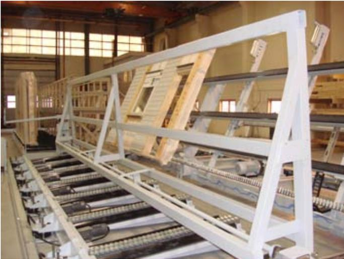
Automatische Stapelbildung der Wandelemente / Automatic stacking of wall elements
