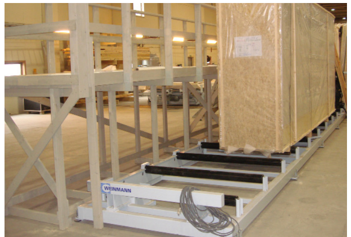
Komisjonowany pakiet ścian stoi gotowy do wysyłki Stacked wall element package ready for shipping
