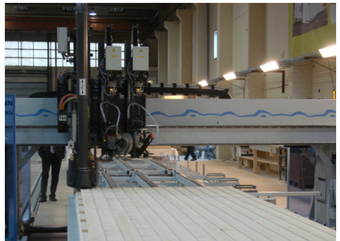
Croirea si capsarea automate a elementelor de placare, cu ajutorul puntii multifunctionale Automatic cutting and planking of the formwork with the multi-function bridge
