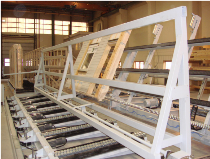
Formarea automată a stivelor de elemente de perete / Automatic stacking of wall elements
