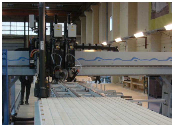
Автоматическое прибивание и форматирование обшивки панели с помощью мультифункционального обрабатывающего моста | Automatic cutting and planing of the formwork with the multi-function bridge
