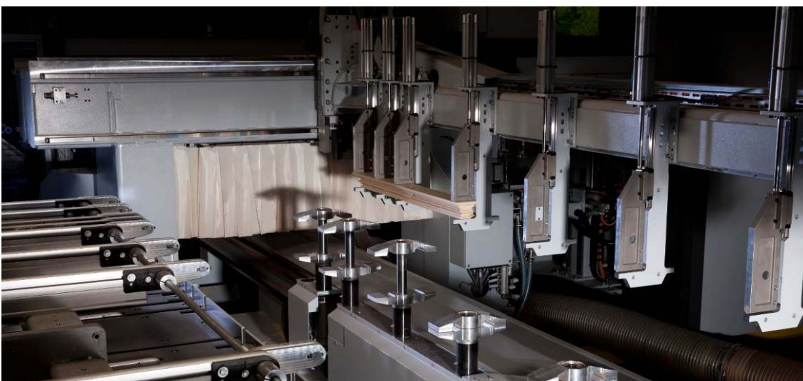
Bild 3: Handlungseinheit zum präzisen Ein- und Umspannen
