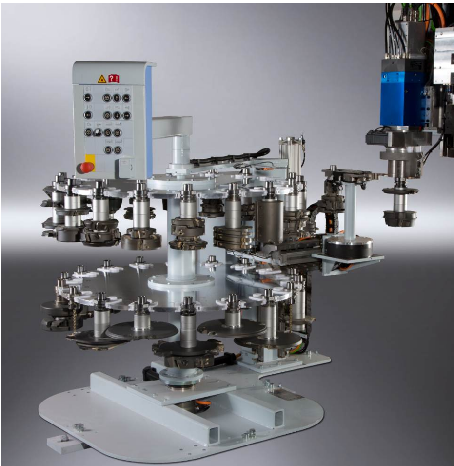
Bild 5: ToolTower Werkzeugspeicher: Kapazität satt und kurze Werkzeugwechselzeiten
