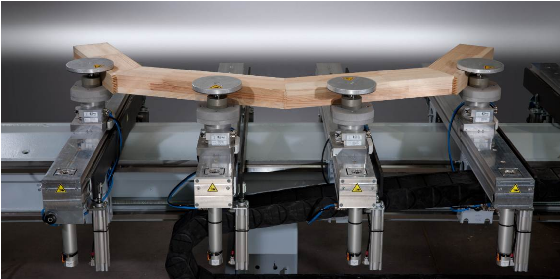
Bild 4: Alles in einer Maschine: Zusatzkonsolentisch für Bogenteile und Türen
