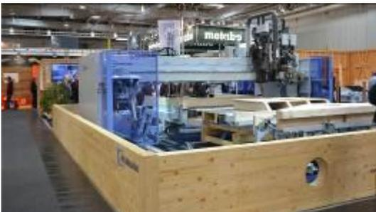
**Bild 4: Automatisierte Herstellung des Riegelwerks mit der kompaktPLUS**
