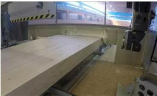
Bild 6: Massivholzportal WMP mit automatischer Bauteilerfassung
