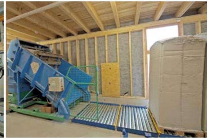
Die Großballenanlage steht auf einem Wiegerahmen, der im laufenden Betrieb permanent kontrolliert, wie viel Material dem System beim Einblasen entnommen wird.
