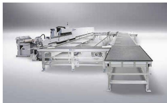
Der Bekanter KAL 310 mit Rückführung arbeitet mit Barcode und Klartextmeldungen für den Bediener
