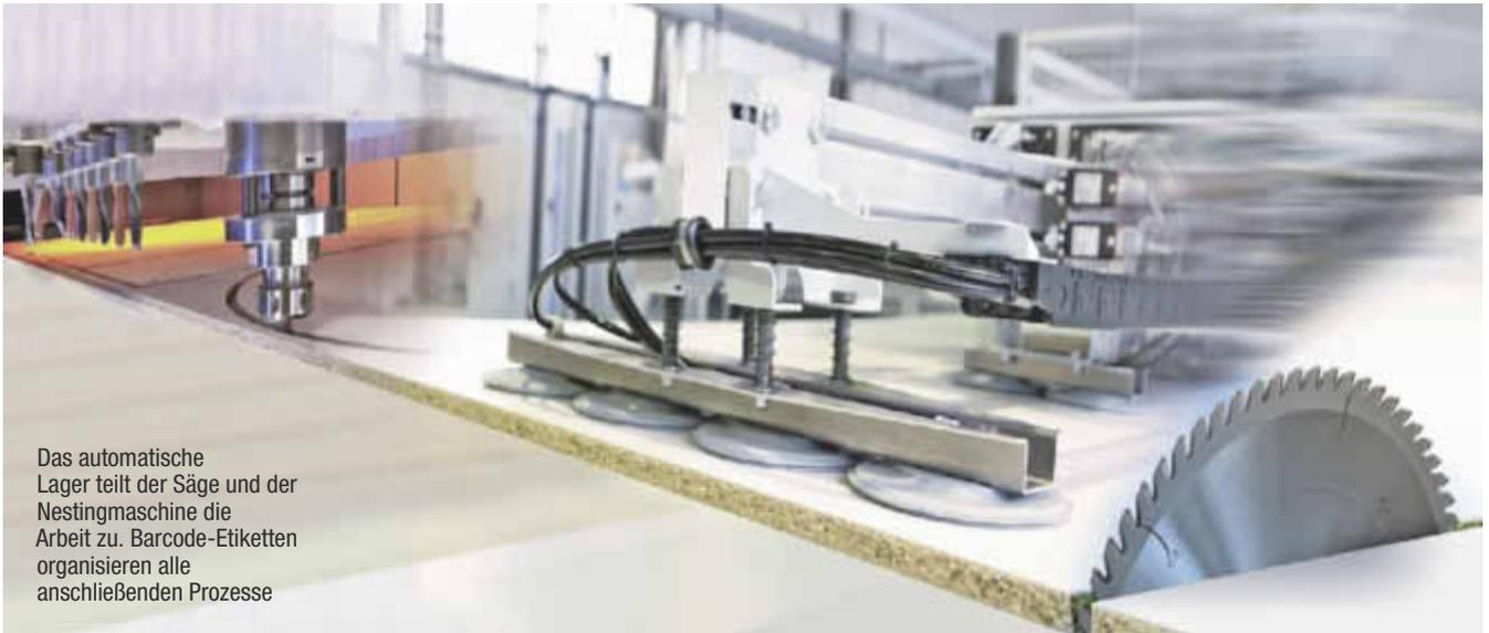
Das automatische Lager teilt der Säge und der Nestingmaschine die Arbeit zu. Barcode-Etiketten organisieren alle anschließenden Prozesse
