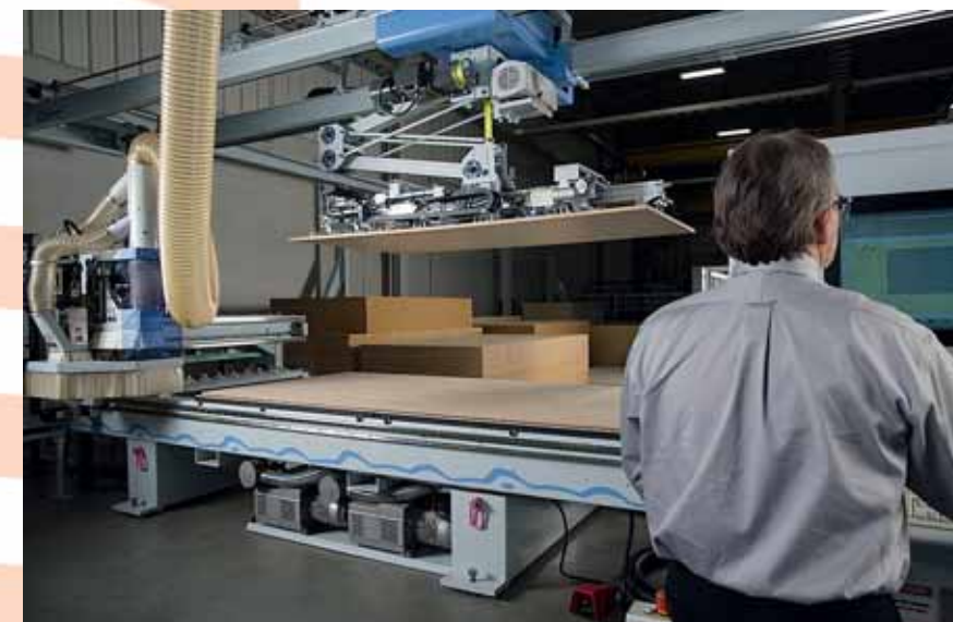
Automatische Plattenlager kommen vermehrt auch in den USA zum Einsatz
