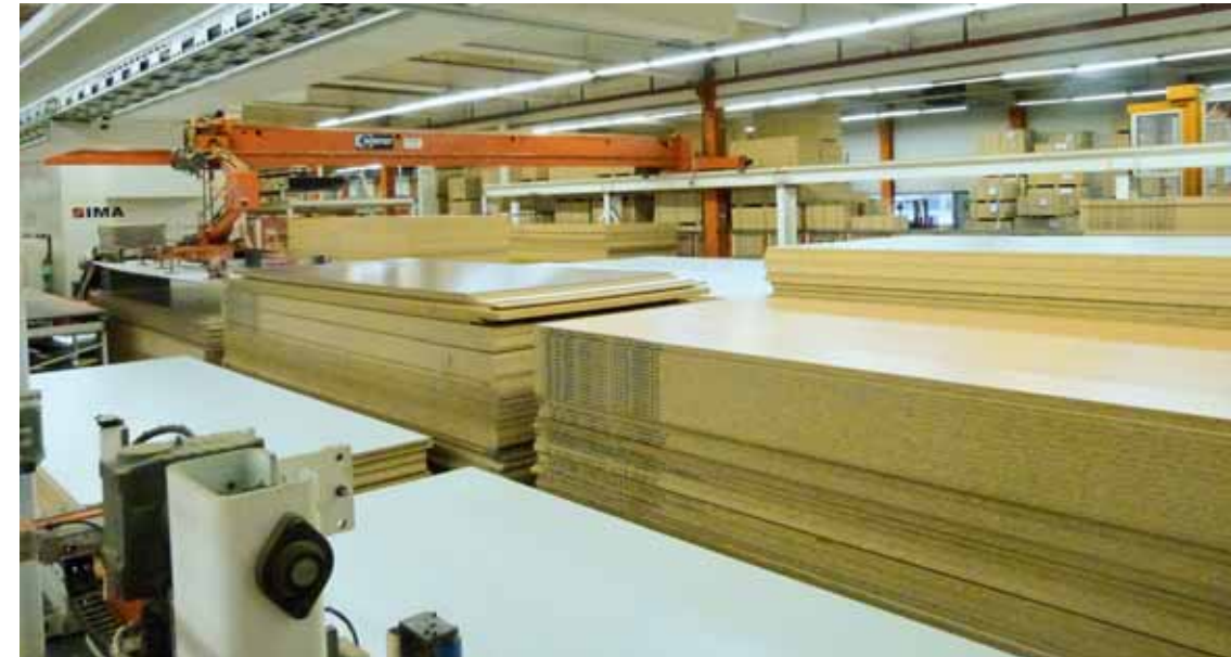
Ganz links: Blick in den Sortier- und Pufferspeicher, rechts im Bild der Rechen, der auf neue Werkstücke zum sortieren wartet. Links: Am Anfang der C-Teile-Fertigung steht ein Flächenlager von Bargstedt
